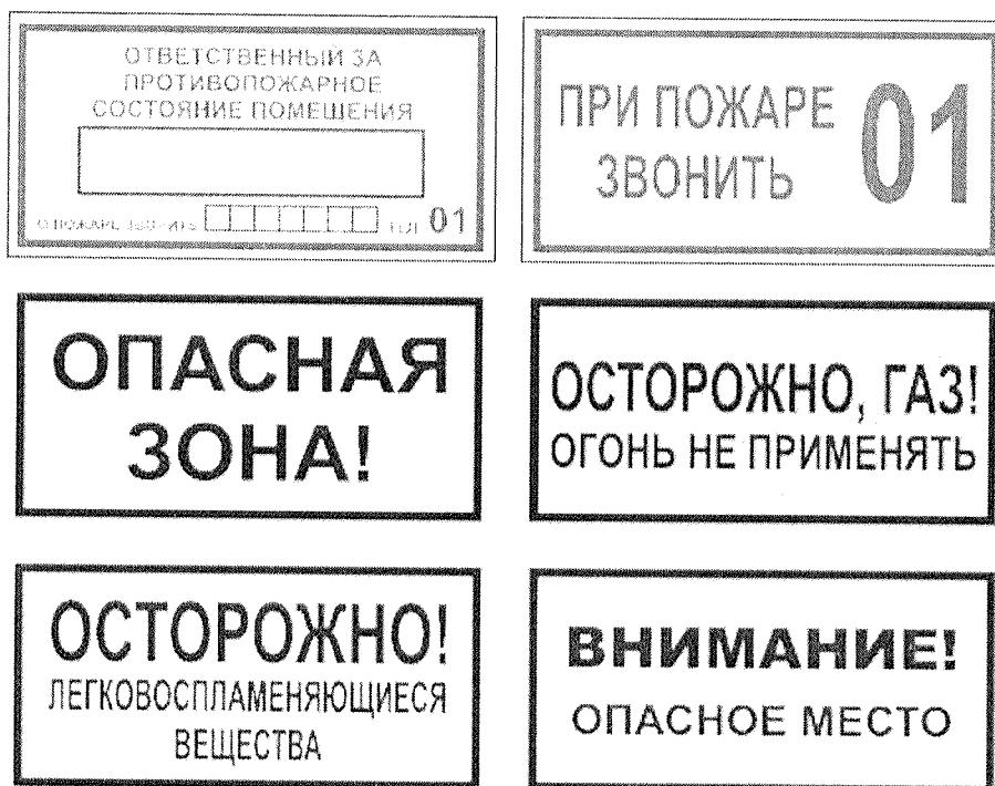
Рисунок 3. Примеры дополнительных знаков безопасности
