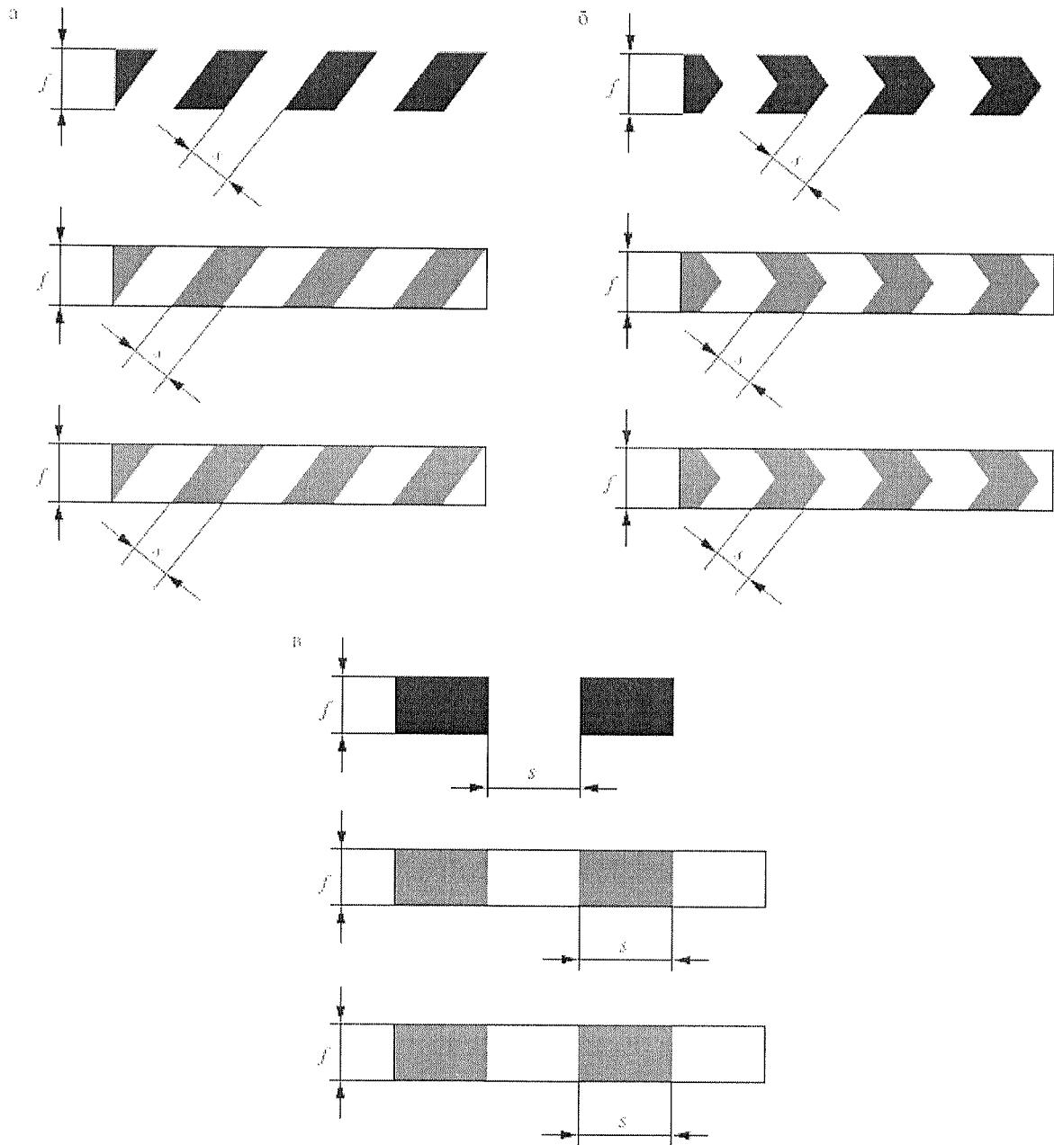
$f$  – поперечный размер сигнальной разметки;  $s$  – ширина полосы сигнального цвета; а – расположение полос наклонно; б – расположение полос зигзагообразно в виде «елочки»; в – расположение полос прямо (вертикально или горизонтально).
